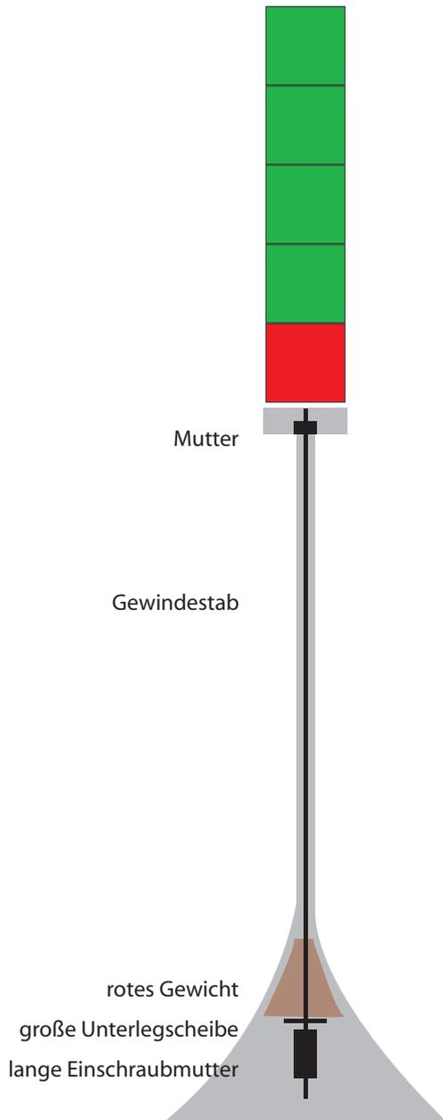
Mittels der Gewindestange und den beiden Muttern, verspannen Sie das Anschlussgehäuse, die Stange sowie den Fuß miteinander .
